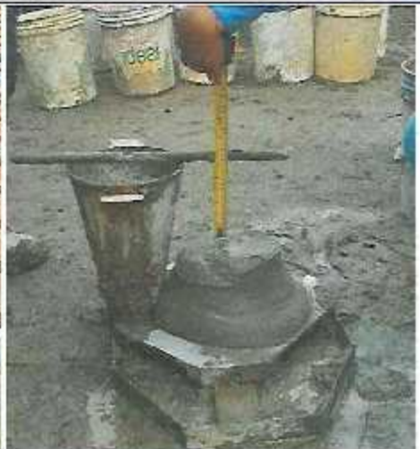
Ensayo de Slump de los diversos concretos colocados en el vaciado de losa aligerada en el Eloque A-6.
