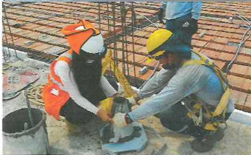
Ensayo de Slump de los diversos concretos colocados en el vaciado de losa aligerada en el Eloque A-6.
