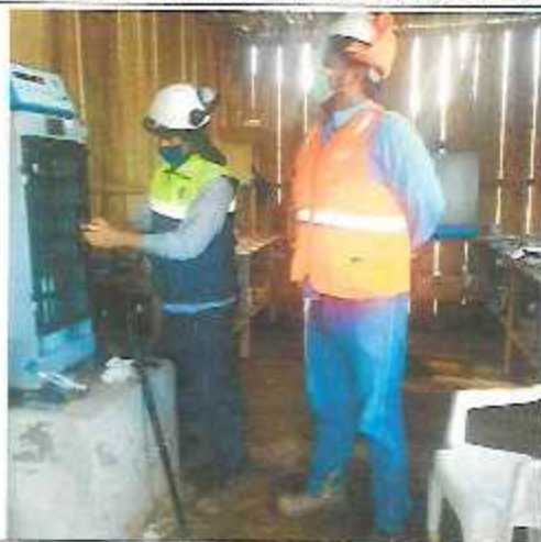
Ensayo de Resistencia a la Compresión de testigos extraídos en campo de vaciados realizados.
