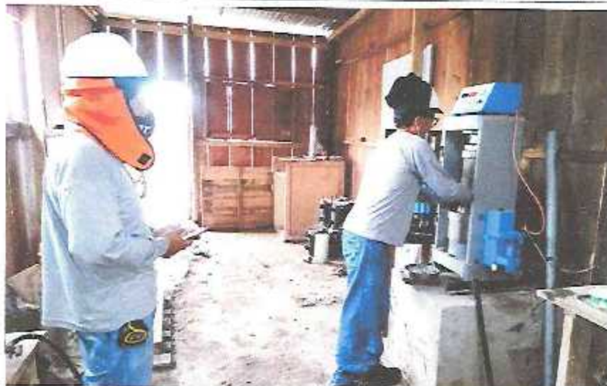
Ensayo de resistencia a la compresión de especímenes muestreados en campo de diversos vaciados.
